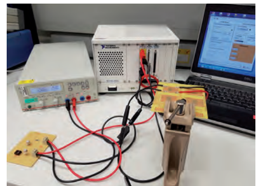
Abb. 92: Automatisierte softwaregestützte Strommessung
