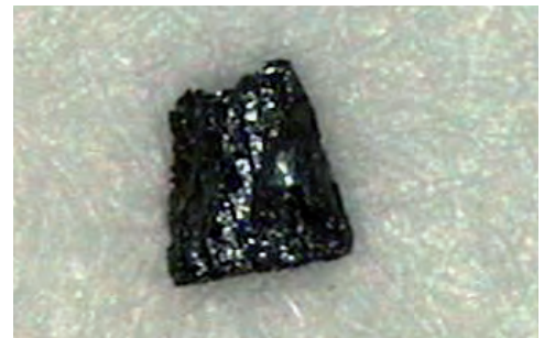
Abb. 33: Ferritpartikel, erkannt als Nichtmetall (558 µm)
