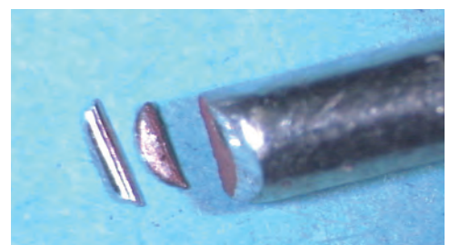
Abb. 24, 25: Abgefallene Partikel vom geschnittenen Draht D = 1,8 \text{ mm} (Kupfer verzinkt)
