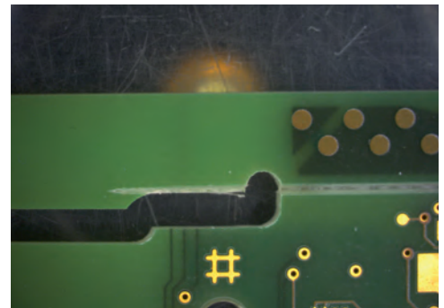
Abb. 58: Ritzstrecke liegt auf Fräskante
