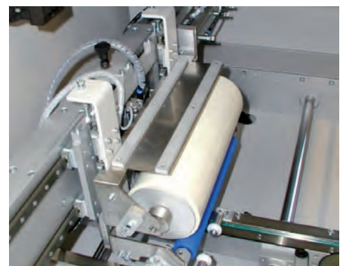
Abb. 86: Adhäsionsrolle für die Durchlaufreinigung von Leiterplatten
