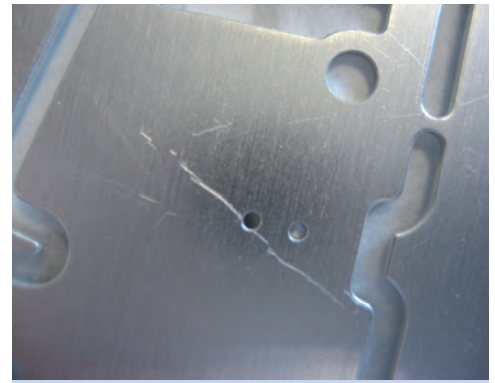
Abb. 67: Beschädigte metallische Versteifung
