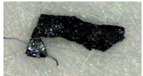
Abb. 34: Nichtmetallischer Partikel, vermutlich Grat oder Kunststoffrest (217 µm)
