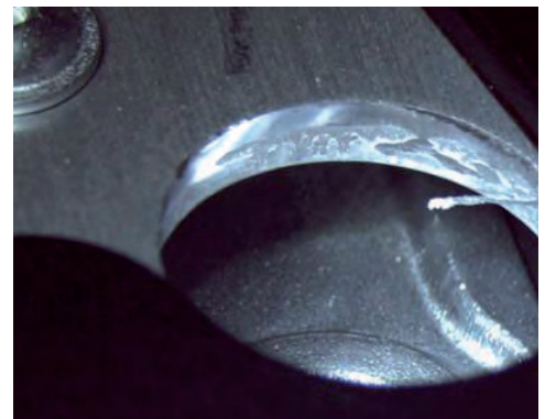
Abb. 69: Stanzreste durch Beizen gelöst
