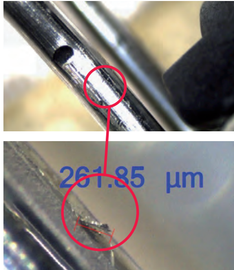
Abb. 27: Detaildarstellung mit Vermessung der Partikellänge
