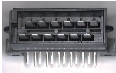
Abb. 52, 53: 12-poliger Stecker mit überbrückten Kontakten
