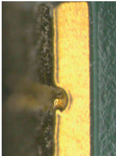
Abb. 61: Anbindungen für galvanische Vergoldung
