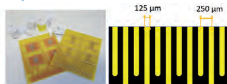
Abb. 90: SIR Testleiterplatten (Layout als verzahnte Kammstrukturen)
