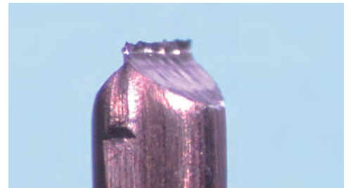
Abb. 23: Seitenschneider-Schnitt am Kupferdraht D = 2,25 \text{ mm} , Gratbildung
